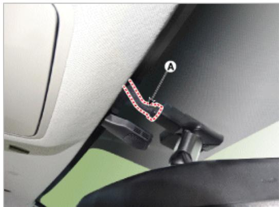
3. 向箭头方向拉并拆卸后视镜(A)。
